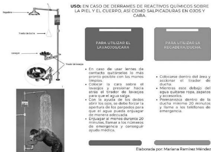
Figura 2. Uso y funcionamiento del lavaojos y la regadera.
