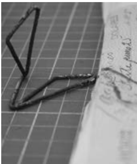
Imágenes 8 y 9. Proceso de retiro de clip oxidado.
