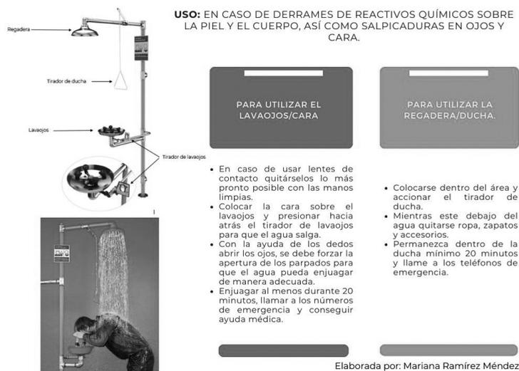
Figura 2. Uso y funcionamiento del lavaojos y la regadera.
